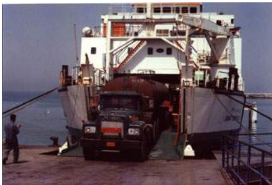
شکل پ-ب-۱۵- قایق ایران هرمز با شیب‌راهه باز که کامیون‌ها در حال پیاده شدن از آن می‌باشند
