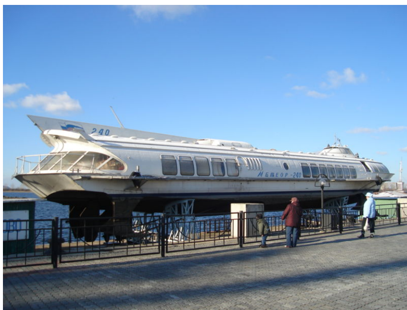
شکل پ-ب-۱۰- نمونه‌ای از یک قایق مسافری هیدروفویل
