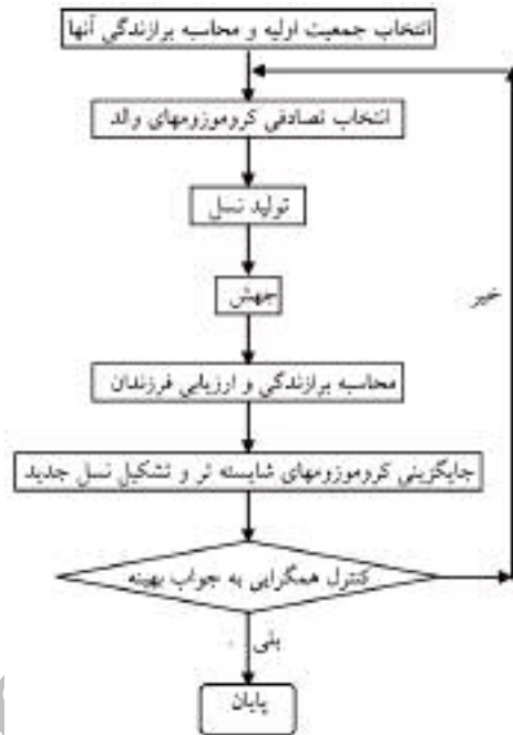
شکل ۲ - فرایند به کارگیری الگوریتم ژنتیک
