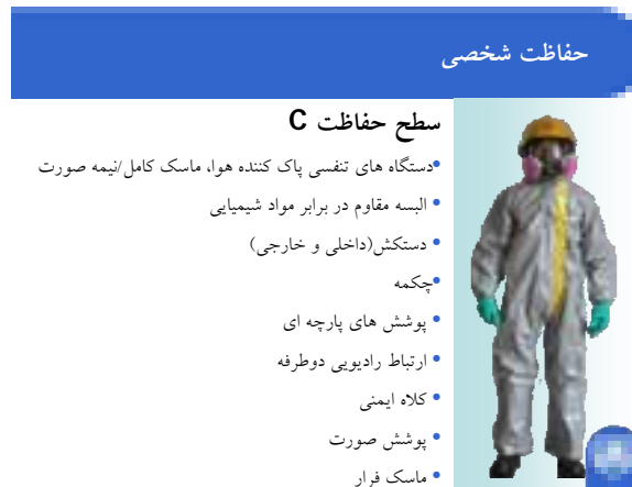
شکل ۷-۱۷: ویژگی‌های پوشش حفاظتی سطح C
