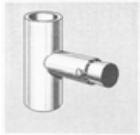
تصویر شماره (۲۸) : از یک پلاک چوبی برای کور کردن خط لوله کم فشار استفاده می شود.
