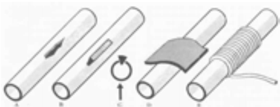
تصویر شماره (۲۴): یک نمونه پیچ نرم . A ، پارگی لوله B و C ، چوب نرم که در پارگی گذاشته شده D
